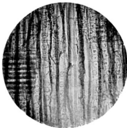
Fig. 2. Radialer Lignin-Längsschnitt. Die Hoftüpfel sind noch deutlich zu sehen.
